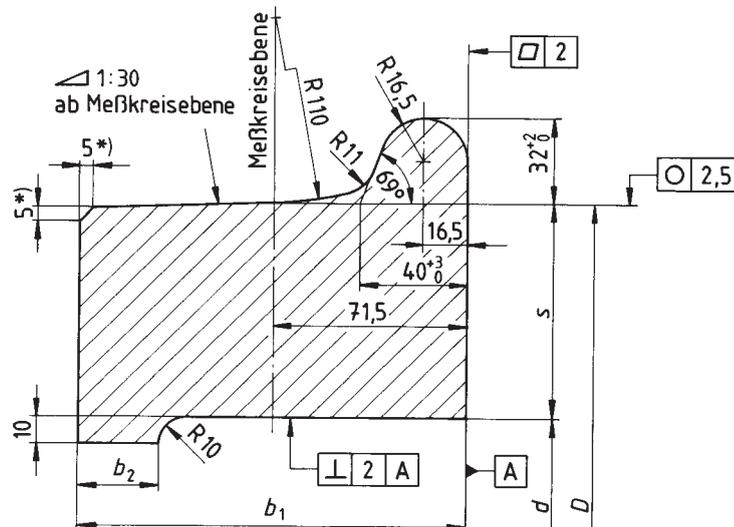
Bezeichnung eines rohen Radreifens Profil E mit den Rohmaßen Meßkreisdurchmesser  $D = 1005$  mm, Breite  $b_1 = 138$  mm,  $b_2 = 30$  mm, Innendurchmesser  $d = 845$  mm:
